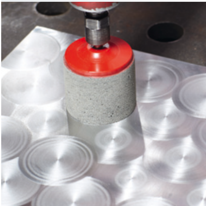
Przykł. zast. ściernic polerskich do marmurkowania P6
