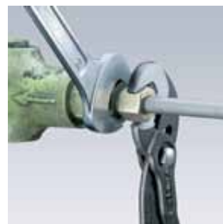
Szczypce wielofunkcyjne używane jako drugi klucz podczas dokręcania nakrętek zabezpieczających
