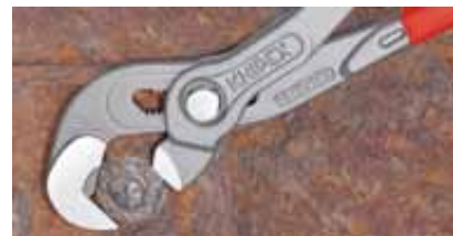
Do odkręcania zabezpieczonych nakrętek z zaokrąglonymi krawędziami
