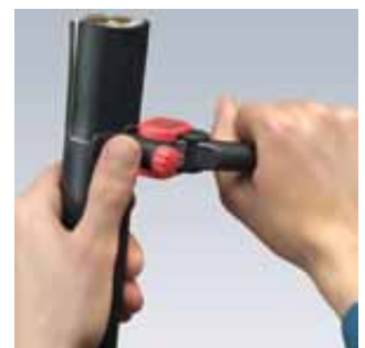
Cięcie po obwodzie
