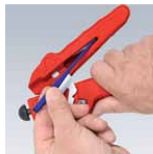
Narzędzie montażowe składa się z trzech trzpieni torpedowych do różnych przekrojów przewodów
