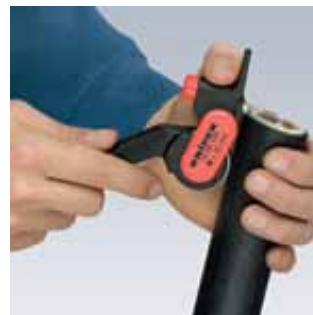
Ustawienie narzędzia do cięcia wzdłużnego
