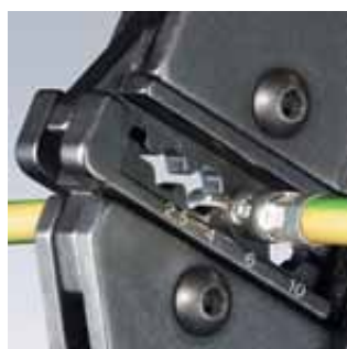
Szczypce do zagniatania typu Crimp System 97 43 200 z matrycą 97 49 30 do końcówek nieizolowanych
