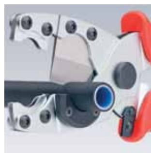
Rury kompozytowe o średnicy Ø 12 - 25 mm są cięte czysto i bez deformacji
