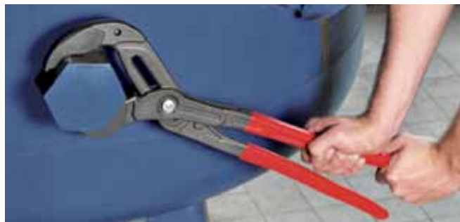
Samozaciskające się na rurach i nakrętkach: nie zsuwają się z chwytanego przedmiotu; wymagają użycia niewielkiej siły
