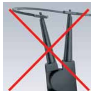
Zwykłe szczypce do pierścieni mogą powodować odkształcanie się pierścienia podczas montażu
