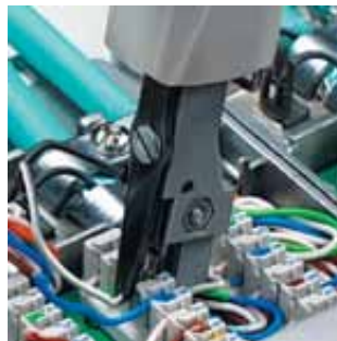
Wciskanie i odcinanie przewodu w jednej operacji
