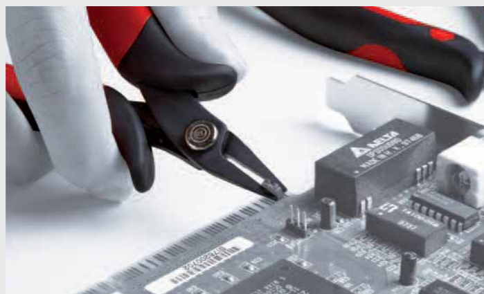
Szczypce ze zwężonymi końcami Electronic Wiha utrzymują małe elementy i zaginają druty.
