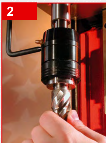
Rys. 2: Włożyć wiertło koronowe EasyLock. Zostaje ono zablokowane z wyraźnym odgłosem „klick”. Pierścień zabezpieczający zaskakuje do dołu.
